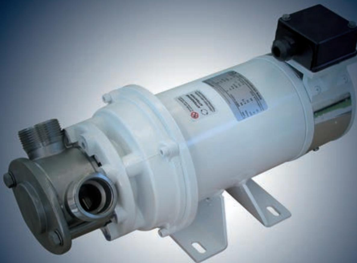
Elettropompe autoadescenti ad anello liquido laterale, utilizzabili per lo svuotamento di sentine ed il travaso di liquidi non infiammabili come: acqua dolce, acqua mare, gasolio, tutti i liquidi a bassissima viscosità ed esenti da impurità solide.
