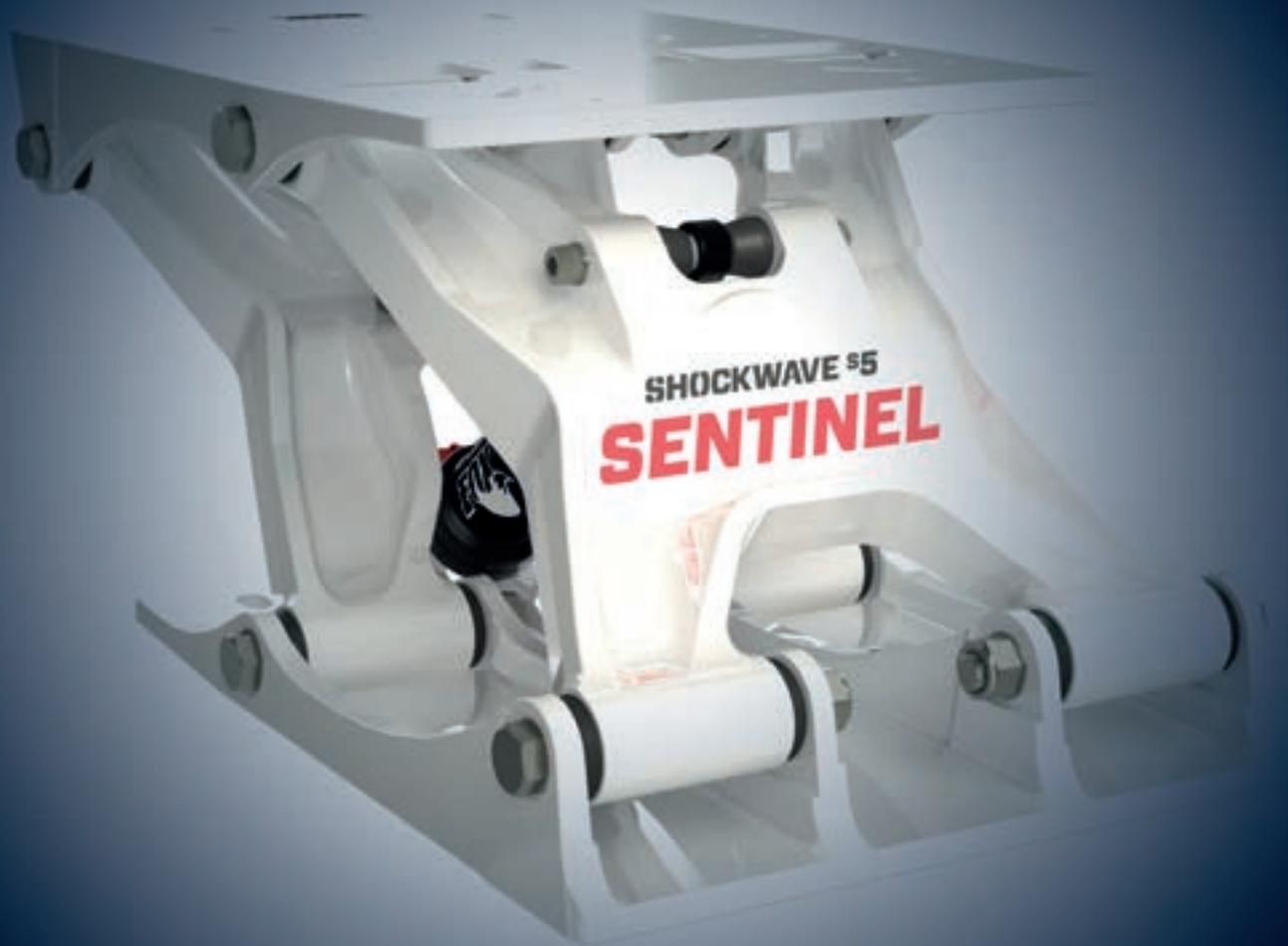
La base di sospensione Shockwave S5 Sentinel è dotata di un ammortizzatore ad aria Shockwave FOX Float H2O con escursione di 100 mm. È facile e veloce da installare praticamente su qualsiasi imbarcazione e può essere montata su una scatola di supporto o su un piedistallo corto e robusto con il minimo sforzo. Il peso massimo degli occupanti per la base S5 Sentinel è compreso tra 113 e 136 kg, a seconda della velocità e delle condizioni del mare.
