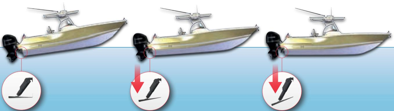
L'uso dei correttori d'assetto elettromeccanici, come quello dei sistemi idraulici, permette all'imbarcazione di mantenere costantemente un assetto adeguato alle varie condizioni di navigazione, consentendo un maggior rendimento del motore, sensibile risparmio di carburante e sicurezza di navigazione.
